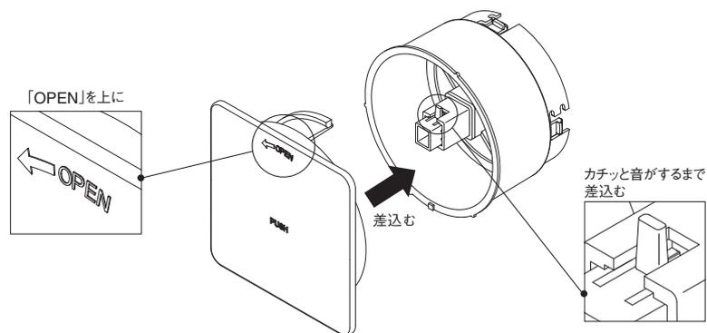
5. シャッターを開いて、フィルター・操作部を取外し時と逆の手順で戻してください。
